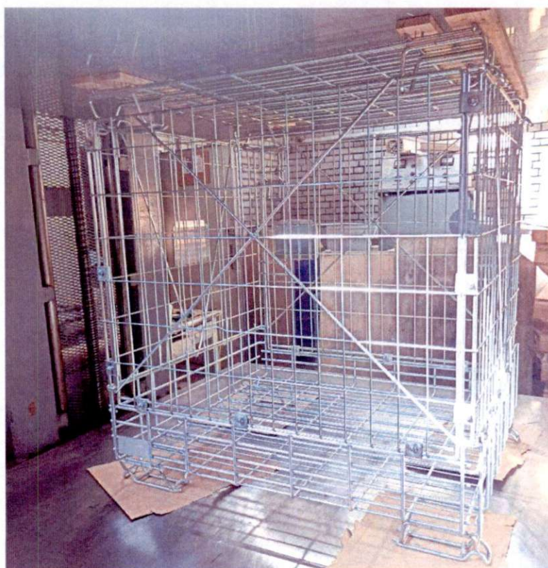
Fot. 6. Pojemnik pod obciążeniem badawczym.
